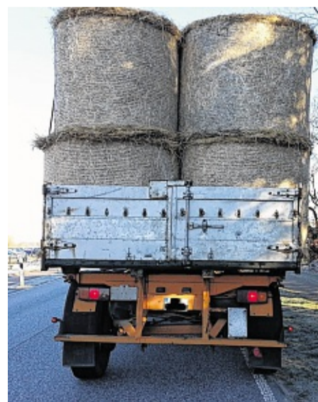
Gefährlicher Balanceakt: Ungesicherte Strohballen auf einem nicht zugelassenen Anhänger.
